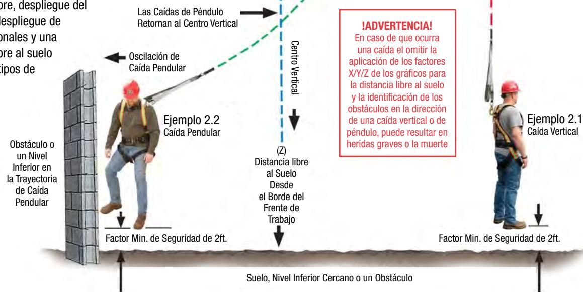
Cualquier desplazamiento alejándose del punto de anclaje resultará en el despliegue de mayor cantidad de cable. Sobrepasar los factores X/Y y Z del Gráfico 2.0 resultará en una longitud de caída superior que podría exceder la capacidad del SRL para detener una caída o evitar que un trabajador se golpee contra un obstáculo en un nivel inferior.
