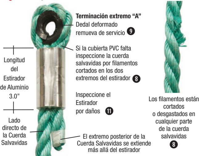
Fig.10a Inspección de la Cuerda Salvavidas
