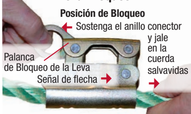
Fig.9a Prueba de la Leva-Bloqueo
