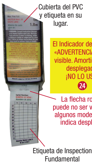
Fig.12 Amortiguador en condición útil.
