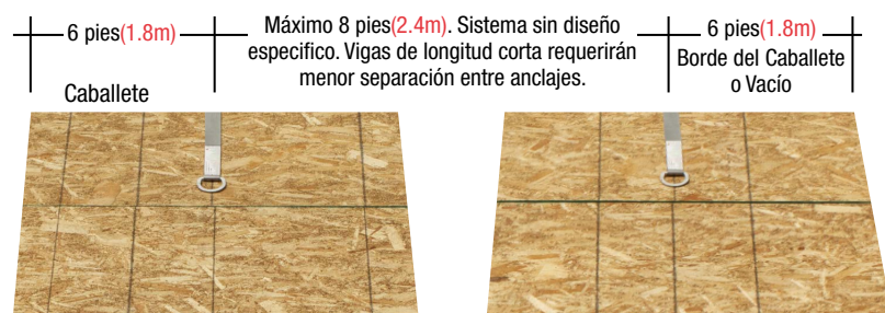
Separación entre Anclas
