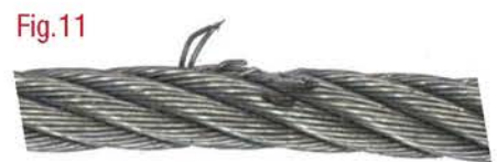
No utilizar acolladores con rebabas, cortadas o gubias.
