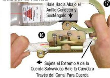
**Fig.10c Posición cerrada del clip de la cerradura **a****
