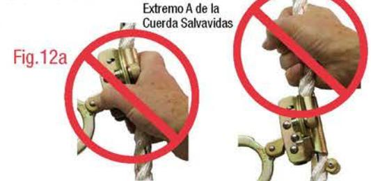
**Inspección/Prueba de Bloqueo del Sujetador de Ajuste Integral**
