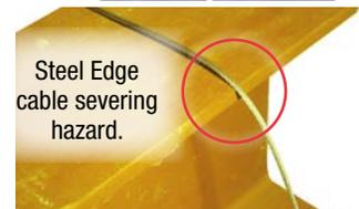
Steel Edge cable severing hazard.
