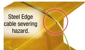
Steel Edge cable severing hazard.
