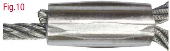
Fig.10 La cubierta PVC del estampado falta. La terminación del estampado es visible.
